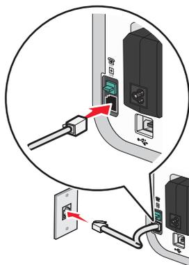
3 从打印机后面的 EXT（电话分机）插口
