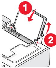
**注意：**为了避免发生卡纸，请确认调节进纸导轨时没有使纸张弯曲。
