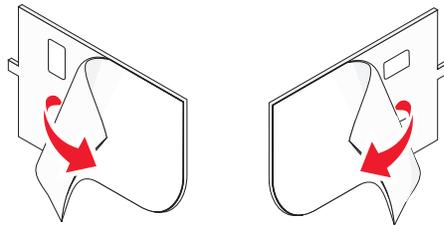
**5** 将面板覆盖层放置在打印机操作面板上的凹槽区域中，然后向下按面板覆盖层。
