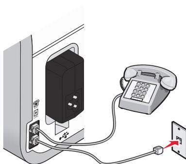
**警告—可能的损坏：**当正在发送或接收传真时，请不要触摸电缆或图中所示的打印机区域。
