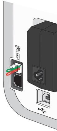
**注意：**请不要去掉保护塞。如果您去掉了保护塞，您家中其他的电信设备（例如电话机或电话答录机）可能无法正常工作。
