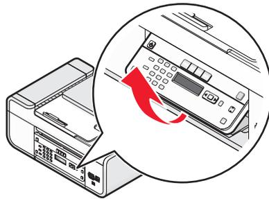
**4** 如果需要粘贴适合于您的语言的面板覆盖层，请从面板覆盖层的背面撕下保护膜并露出粘合层。
