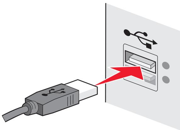
**2** 将较小、较方的一端连接在打印机上。
