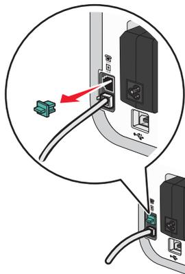
4 使用第二根电话线连接电话机和电话答录机。
