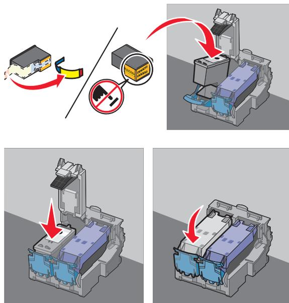
**警告—可能的损坏：** 请不要用手触摸打印墨盒后面的金色触点区域或打印墨盒底部的金属喷头区域。
