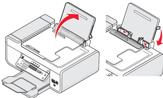
8 装入纸张，然后提起纸张调节杆并调节进纸导轨。进纸导轨应该紧靠纸张的边缘。
