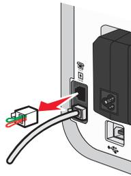
**注意：**当去掉保护塞后，您通过适配器连接在打印机上的任何国家 / 地区的设备（如图所示）都将不能正常工作。
