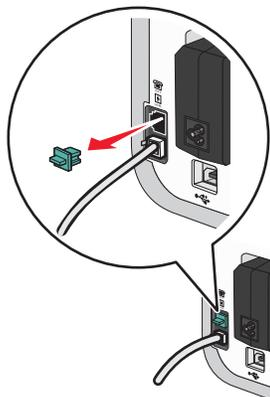
4 使用另一根电话线连接计算机调制解调器和打印机后面的 EXT（电话分机）插口
