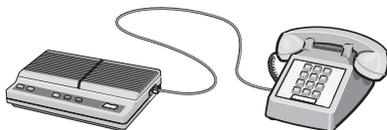
5 使用第三根电话线连接电话答录机和打印机后面的 EXT（电话分机）插口
